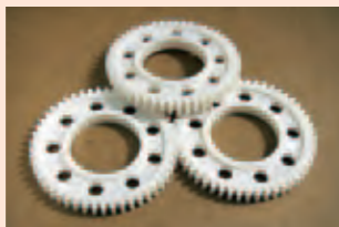
部分バイオPBTで試作した成形品
