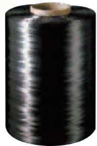
▲東レの炭素繊維 トレカ®。特殊なアクリル系を1000～3000℃の高温で熱処理して得られる繊維で、直径数ミクロンの単糸を数千～数万本束ねたもの。この繊維を樹脂などの母材と組み合わせると炭素繊維複合材料が作られます
