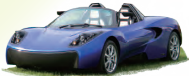
▲2011年に東レグループがグリーンイノベーション戦略を体現するフラッグシップとして制作した次世代型コンセプトEV(電気自動車)「TEEWAVE® AR1」。独自の設計成形技術の適用により大幅なCFRP化を行い、車体重量846kgという軽量化を実現しました
