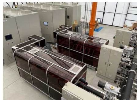
2.3MW級PEM型水電解実証機 (日立造船協力)
