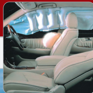
側面衝突対応のカーテンエアバッグの使用例
