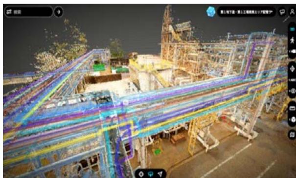
18種類の色分けにより、配管の機能がPC画面上で明確に可視化されている
