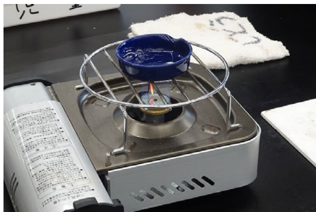
展開2：中空糸膜を使った食塩水のろ過実験 ろ過した液に食塩が含まれているかを確認する。
