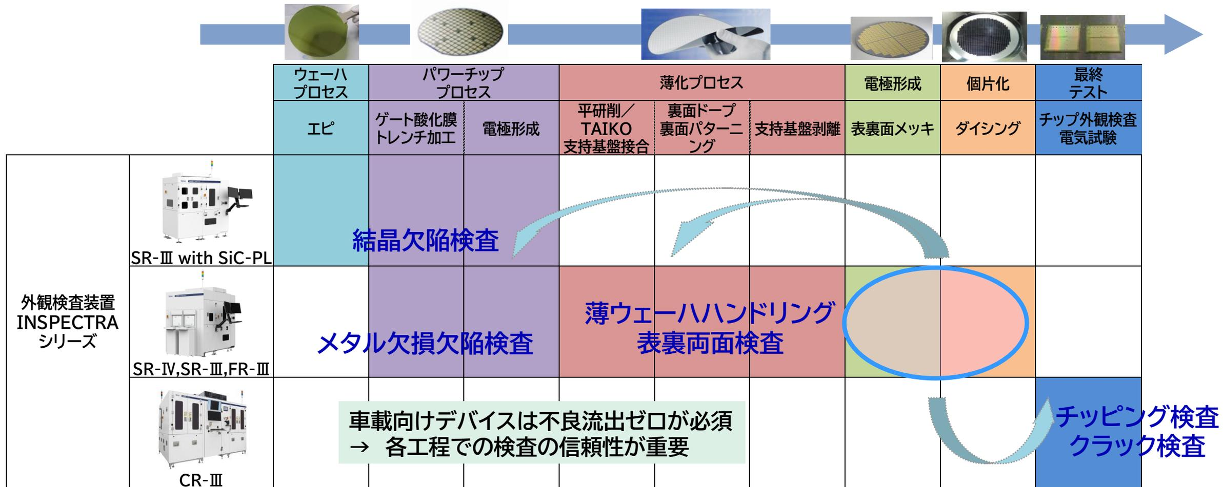
外観検査から前後工程へ適用工程を拡大し、国内主要メーカーでの実績を積み重ねてきた。
