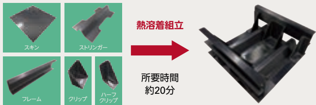
本技術を活用した航空機構造模擬部材(デモンストレーター)の熱溶着組立
