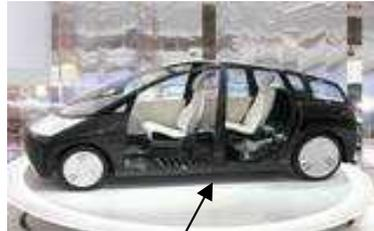
CFRP製次世代軽量車体
