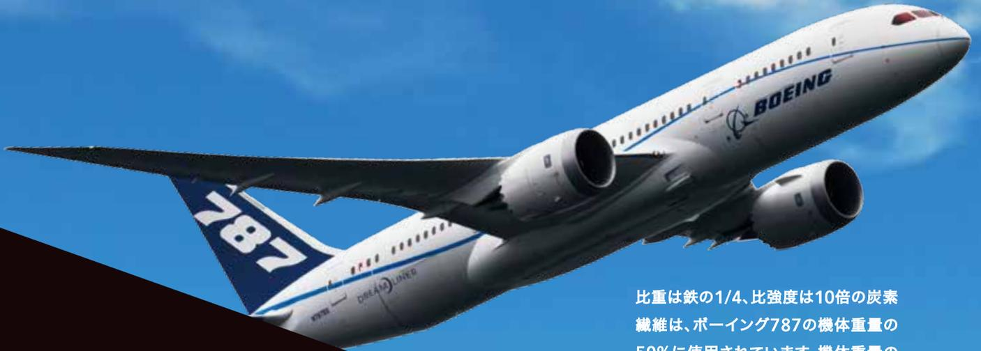
比重は鉄の1/4、比強度は10倍の炭素繊維は、ボーイング787の機体重量の50%に使用されています。機体重量の軽量化により、航空機の環境負荷は大幅に低減されます。
