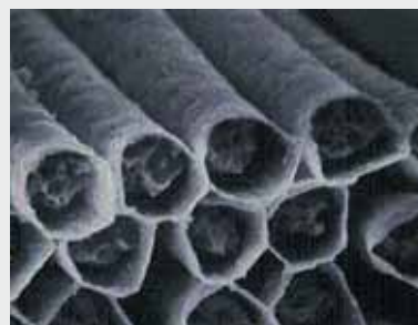
“ナノマトリックス”技術を使って繊維表面に被覆した機能材料繊維の断面写真
