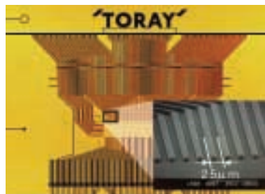
新しい材料とプロセスによりこれまでの限界を超えた次世代フィルム回路基板。
