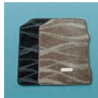
トウモロコシを原料としたポリ乳酸繊維は、トヨタ自動車株式会社の乗用車のフロアマットに採用されています。
