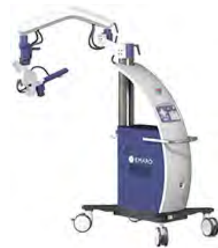
大学発ベンチャー「リバーフィールド株式会社」内視鏡把持ロボット
