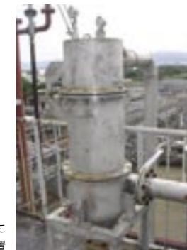
トーレ・プラスチック（マレーシア）に設置した有機系排ガス回収装置
