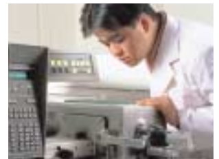
高分解能GC/MSを用いてダイオキシン分析を行っています
