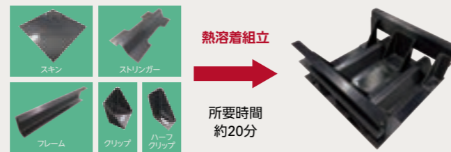
本技術を適用した航空機構造模擬部材(デモンストレーター)の熱溶着組立
