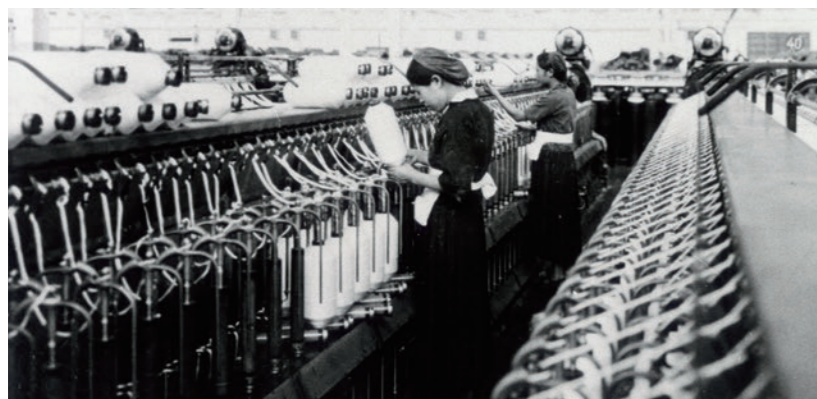
瀬田工場の粗紡機 Seta Plant roving frame
